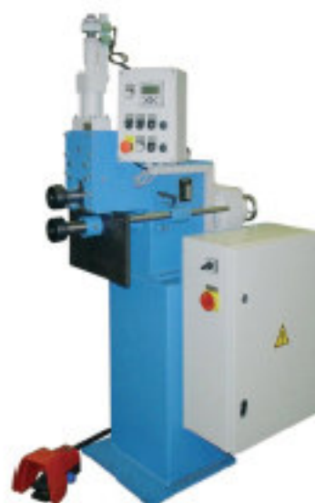
SME 100 silnikowa z hydraulicznym, równoległym dosunięciem walców
